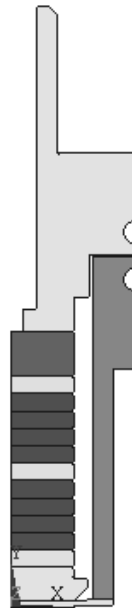
Рис.2 Геометрическая модель датчика давления
