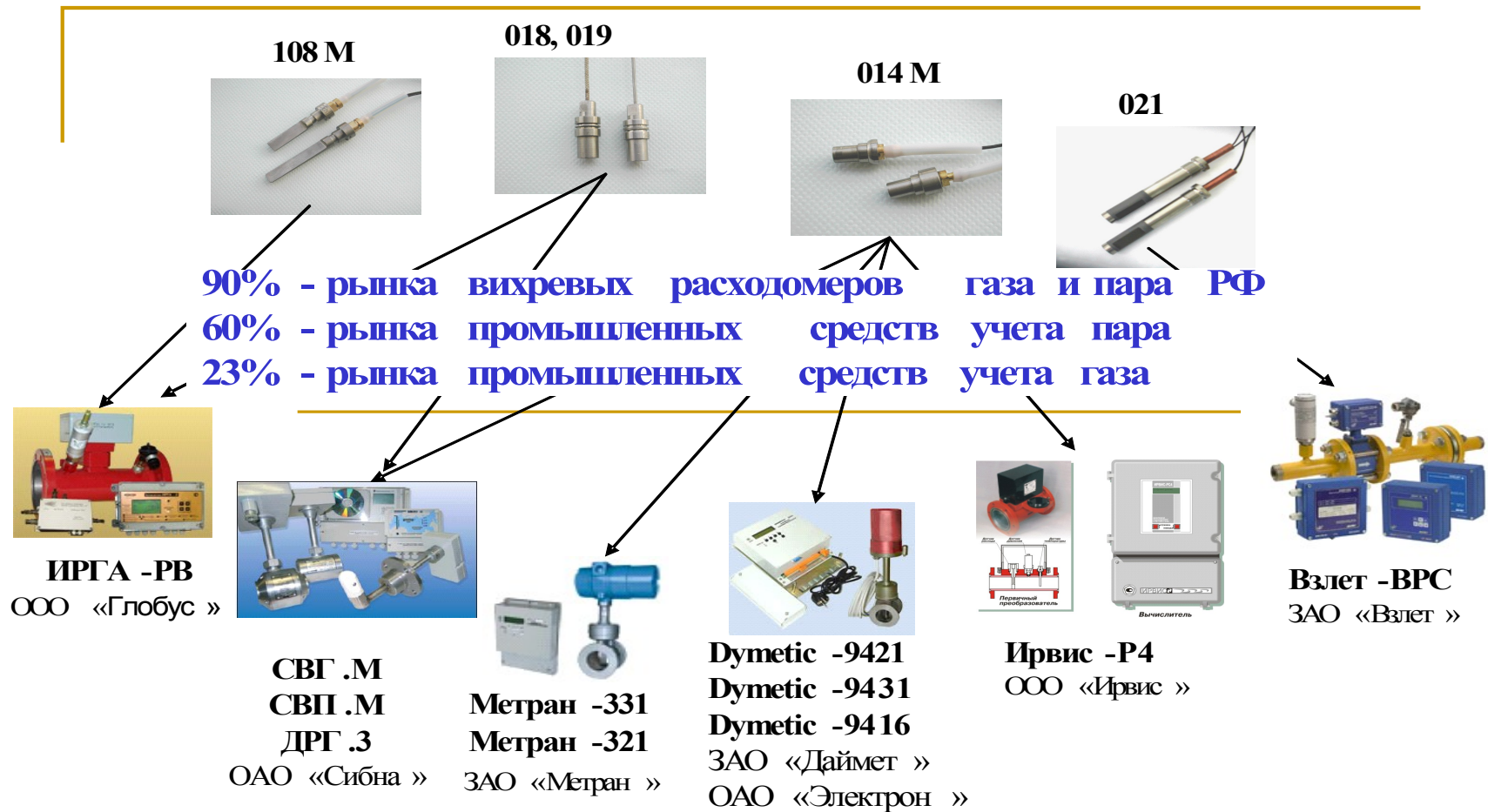
Рис. 5. Пьезоэлектрические датчики и вихревые расходомеры на их основе
