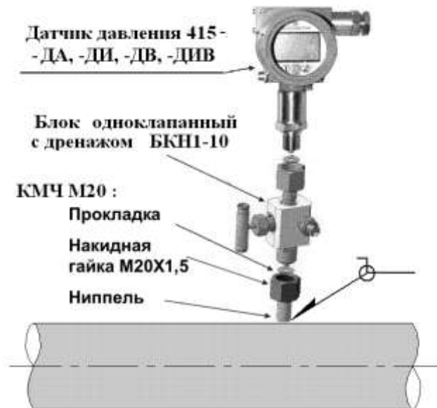
Рисунок 1.11 - Монтаж датчиков моделей 5XX3, 7XX3, 8XX3 и 8XX8
