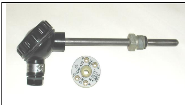
Рис.4.1. Внешний вид термометров и токовых преобразователей
