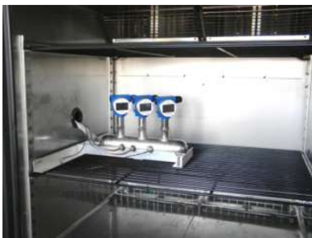
Рис. 7. Внешний вид установки и плотномеров в процессе испытаний.
