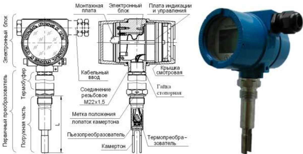
Рис. 4. Устройство и внешний вид плотномера 804.
